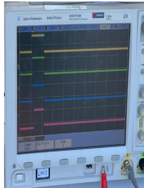
Şekil 10. Dedektör Sinyal Pini Osiloskop Görüntüsü
