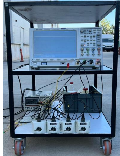
Şekil 2. Dedektör Algılama-Osiloskop Düzeneği
