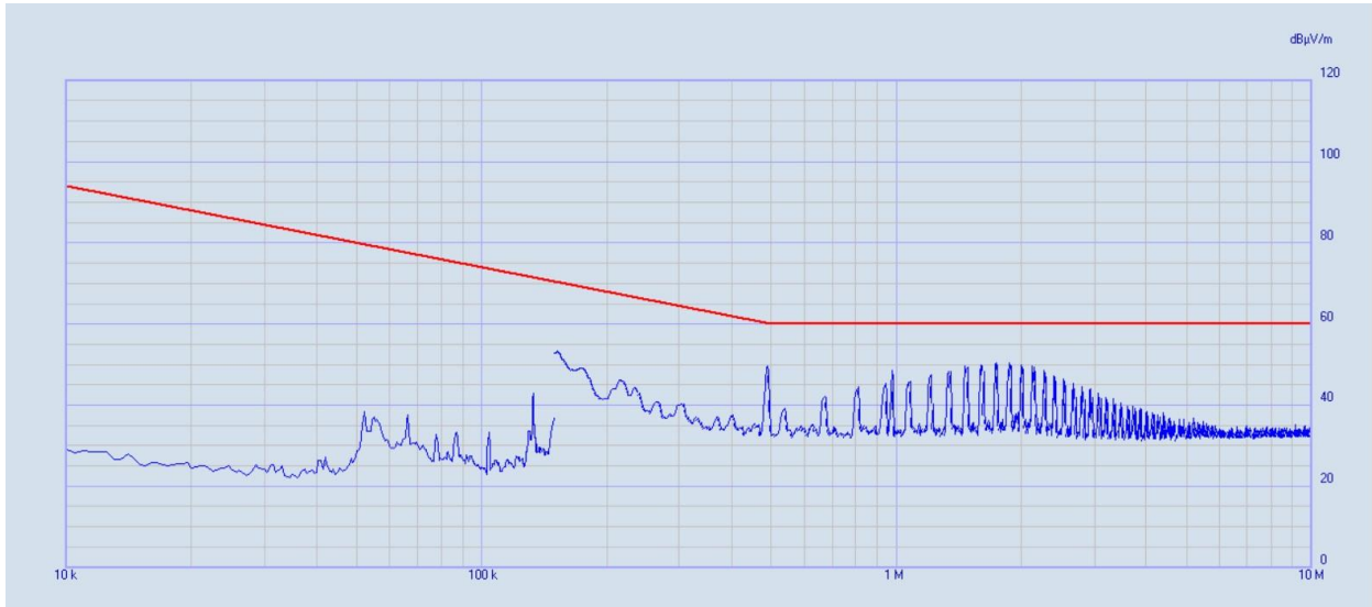
Şekil 17: (+) Hattı (10kHz – 10MHz) Test Emisyon Ölçüm Sonucu
