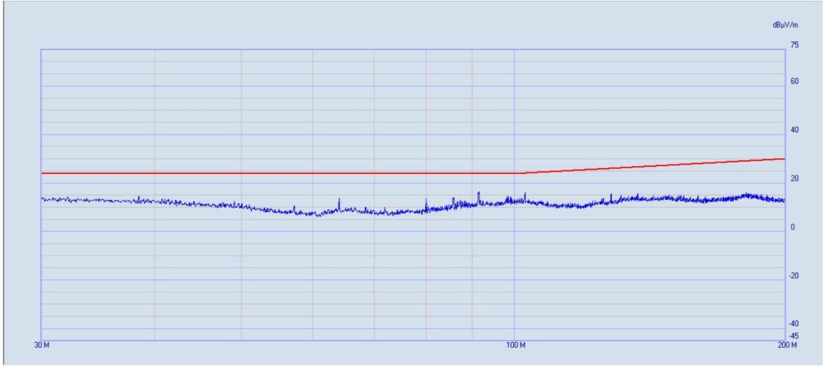
Şekil 69: RE102 30MHz-200MHz Test Ölçümü (Yatay) Figure 69: RE102 30MHz-200MHz Test Measurement (Horizontal)
